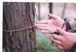
元となるアンカーは引き解けにしたエバンスノットがお勧め。特に太い樹木に細いロープではクロープヒッチでは利きにくい。また、エバンスのほうが必要なロープ長が少ない。
